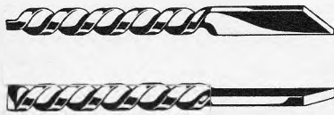
Bild 1. Die Uni-Wendelspitze von Löttring. Sie besteht aus einem flachen Kupferband, die schräg abgesetzte Stirnfläche kann leicht und ohne Querschnittsänderung nachgearbeitet werden
